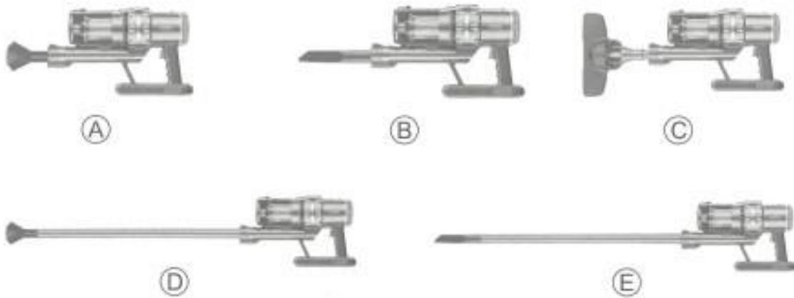
4. Todas las piezas instaladas en la parte frontal son desmontables. El método consiste en mantener pulsado el botón de bloqueo correspondiente y extraer los componentes hacia ambos extremos. Si tira demasiado fuerte, puede apretar hacia dentro y tirar en sentido contrario. (Los estilos de los accesorios pequeños y los cepillos de suelo están sujetos al producto real)
